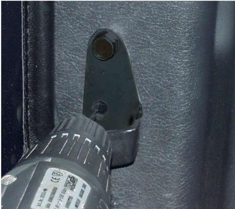
Nécessite le percement d'un trou supplémentaire
