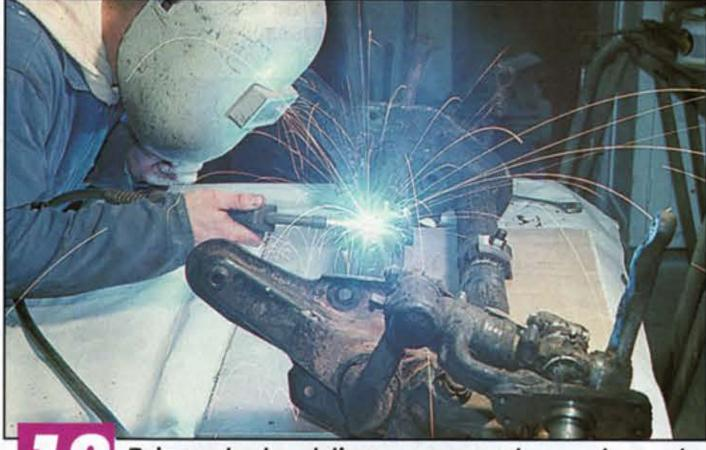
Puis soudez les platines avec un cordon sur chacun des quatre côtés. Attention, un côté mord quasiment sur l'un des trous percés précédemment : ne soudez pas la bague !
