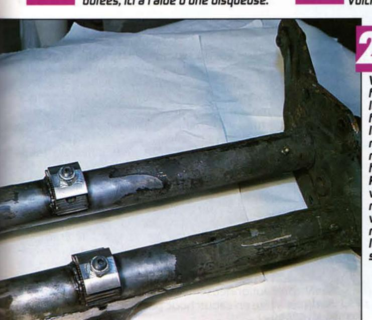
Voici le résultat final. Utilisez les écrous-frein fournis pour serrer le kit. Il ne vous reste plus qu'à remonter le train en place. Positionnez les vis environ à mi-hauteur, vous affinerez le réglage une fois le Combi sur ses roues.
