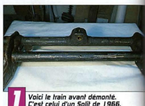
C'est celui d'un Split de 1966. Nous n'avons pas démonté les bras de suspensions. Notez le renvoi de direction au milieu du tube inférieur.
