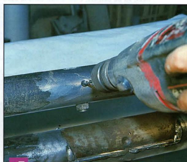
Pour cela, faites un avant-trou avec une mèche de 4 ou de 5. Ne percez pas plus de 3 ou 4 mm.
