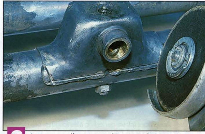
Avec une disqueuse, découpez les soudures qui maintiennent en place le renvoi de direction. Découpez juste au-dessus des soudures, comme sur la photo, sans découper le tube!
