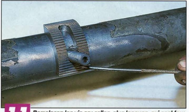
Remplacez les vis par celles, plus longues, qui sont four-nies dans le kit. Présentez les platines, qui seront ensuite soudées aux tubes. Pour obtenir le maximum de latitude dans le sens du droppage, positionnez la cale à fond contre la vis, qui est ici dans la position d'origine. La photo montre le tube supé-rieur, vu de derrière, c'est-à-dire dans le sens de la marche.
