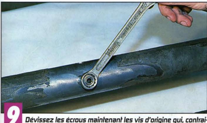
Dévissez les écrous maintenant les vis d'origine qui, contrai-rement à celles d'une Cox, se trouvent vers l'arrière du train
