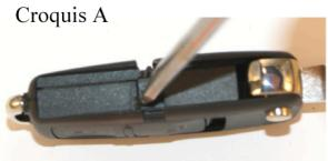
Ensuite, ouvrir le boîtier en deux et procéder à la mise en place des éléments électronique sur la nouvelle coque.
