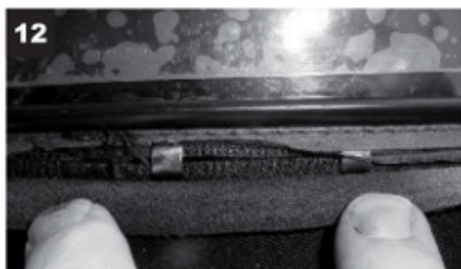
■ Mettre en place l'agrafe de sûreté sur la fermeture à glissière côté extérieur.
